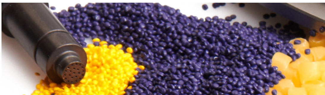
Exemplo de saída com vários orifícios com 22 orifícios com \varnothing 0,4 mm
