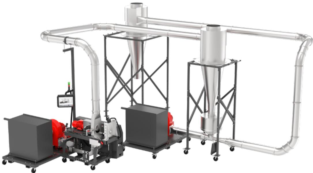
Renovação adicional do ar através de uma ventoinha com injetor de ciclone e tubos para o alcance de uma temperatura final dos péletes mais baixa.
