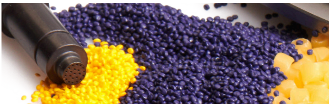
Beispiel Mehrlochdüse mit 22 Löchern à Ø 0,4 mm
