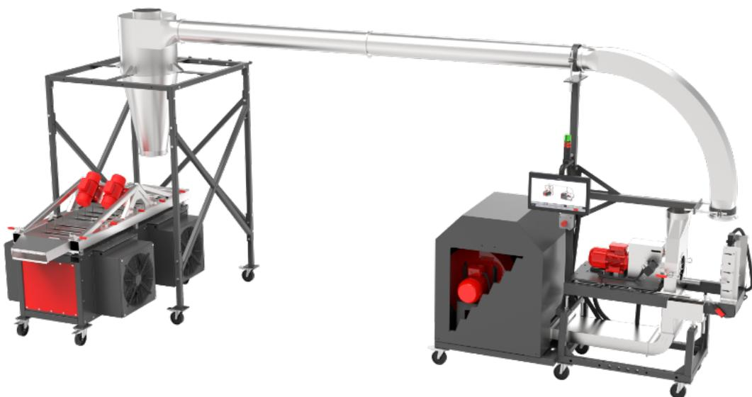
Das **ECON**-Vibrationssystem liefert ausgezeichnete Kühlleistung, während das Granulat langsam zum Auslass bewegt wird.
